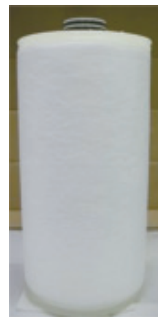
放射線グラフト重合法で合成した強アルカリ溶液でも金属イオンを吸着除去できる高性能フィルター（高さ25cm）
